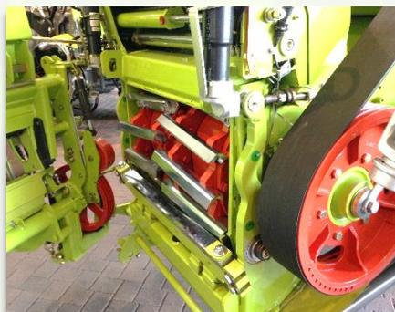
Abb. 2: Fotografie des Häckselaggregats mit montierten Messern
